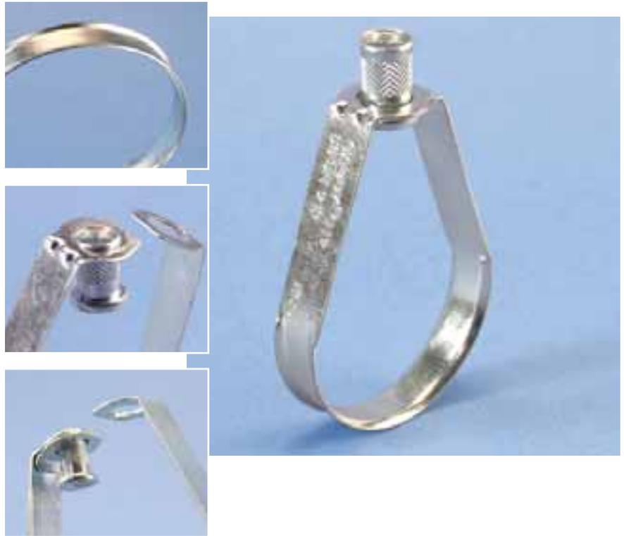
El soporte tipo pera 112, parte de la línea de abrazaderas, sujeciones y soportes CADDY<sup>®</sup> de ERICO, es ideal para colgar tuberías estacionarias no aisladas, incluyendo tubos de CPVC, de sistemas de protección contra incendios. La tuerca roscada insertada simplifica los ajustes verticales, y la abertura abocinada mantiene la tuerca unida a la abrazadera en todo momento, para una mayor comodidad y para eliminar la frustración que produce la pérdida y caída de tuercas.
